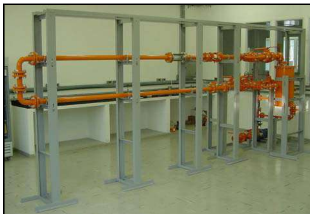
Figura 2.13 – Sistema dinâmico tipo loop construído no Laboratório de Corrosão e Proteção do IPT.
